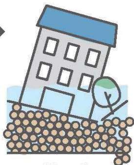
地震後 砂下沉，水上浮， 瞬間失去承載力
